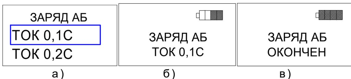
Рисунок 3.1 – Сообщения на табло при заряде блока аккумуляторного с Ni-MH аккумуляторной батареей
