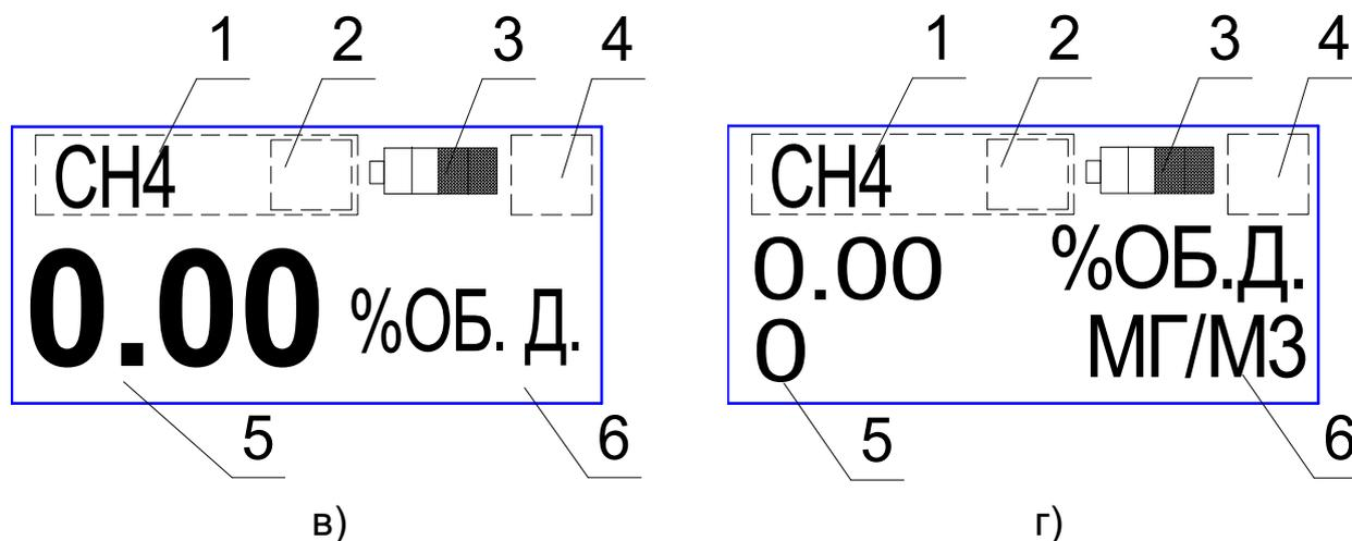
Рисунок 1.5 – Вид табло сигнализаторов в режиме «ИЗМЕРЕНИЯ»
