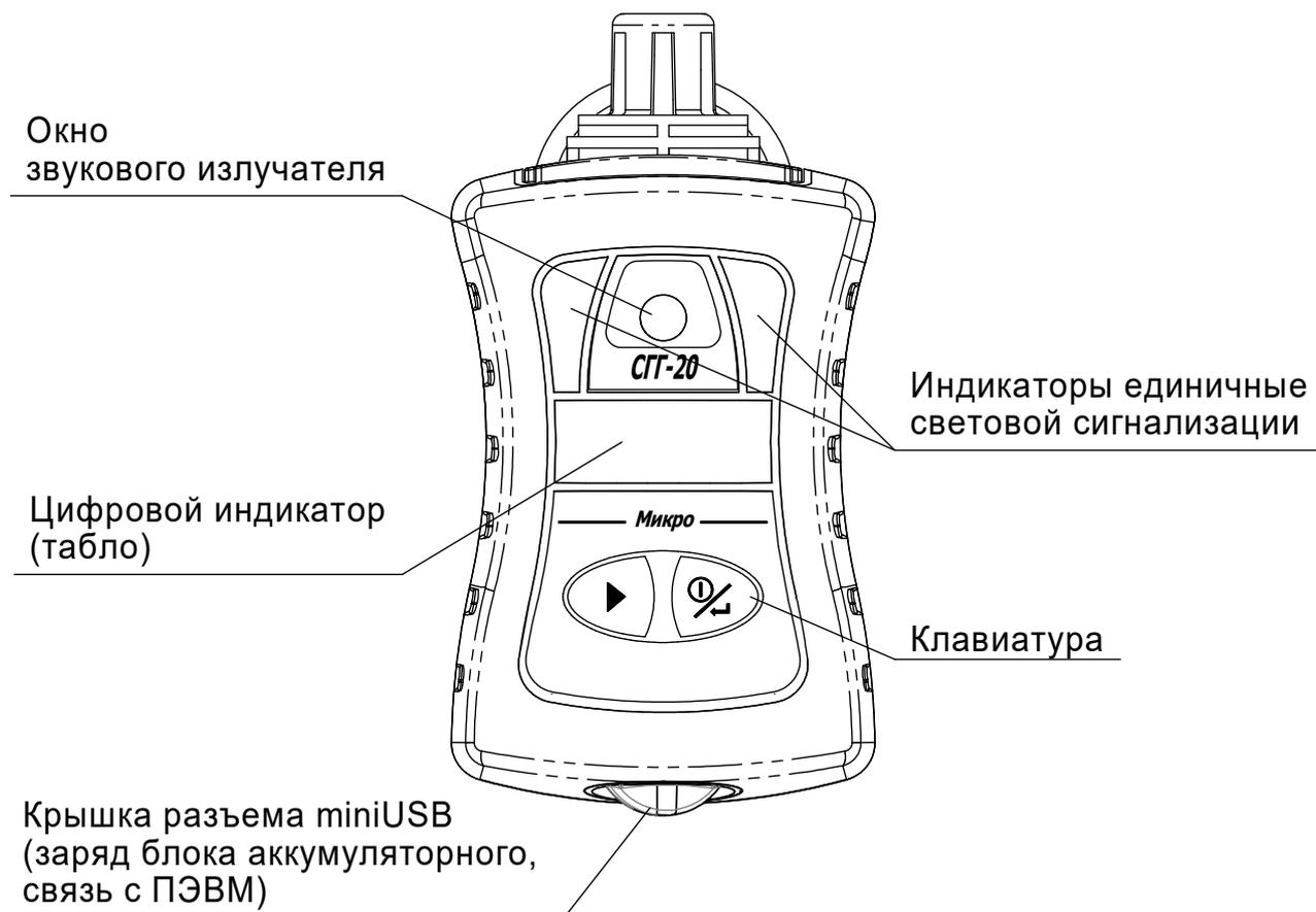
Рисунок 1.2 - Органы управления и индикации сигнализаторов
