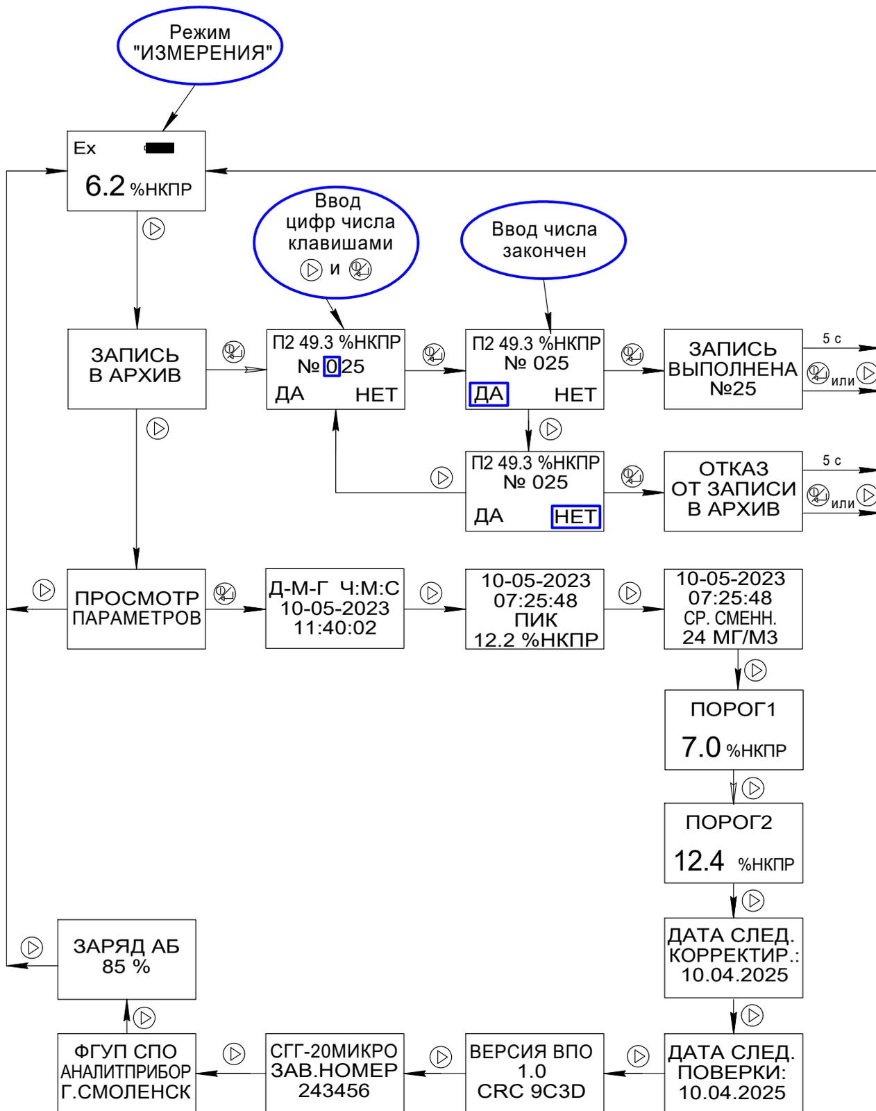
Рисунок Б.3 – Структура меню быстрого доступа
