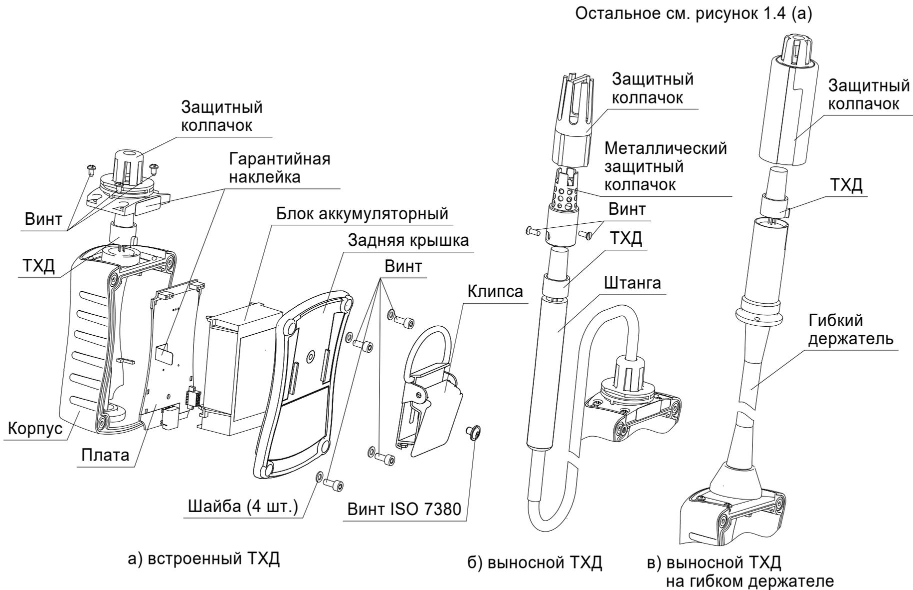
Рисунок 1.4 – Устройство сигнализаторов
